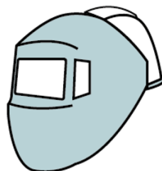
Pantalla de soldadura montada en un casco de uso industrial
